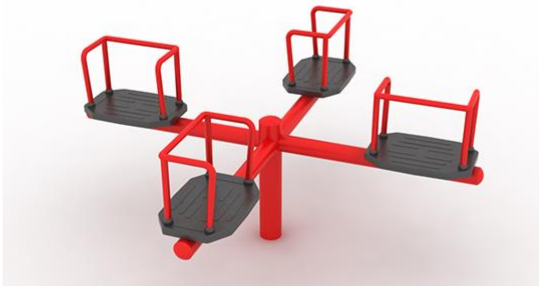
Karuzela- konstrukcja stalowa - cynkowana ogniowo i malowana proszkowo, siedziska gumowe. Wymiary: średnica: 1,84m; wysokość: 0,85m.
