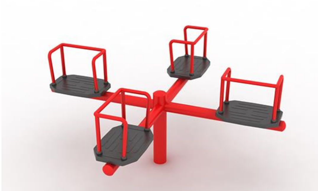
Karuzela- konstrukcja stalowa - cynkowana ogniowo i malowana proszkowo, siedziska gumowe. Wymiary: średnica: 1,84m; wysokość: 0,85m.
