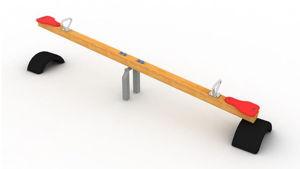
Huśtawka wagowa- Belka pozioma 100x100mm - drewno klejone, siedziska - płyta HDPE, uchwyty - stal nierdzewna , kotwa stalowa - cynkowana ogniowo. Wymiary: Szerokość: 0,29 m Długość: 2,99 m, Wysokość: ~ 0,9 m.
