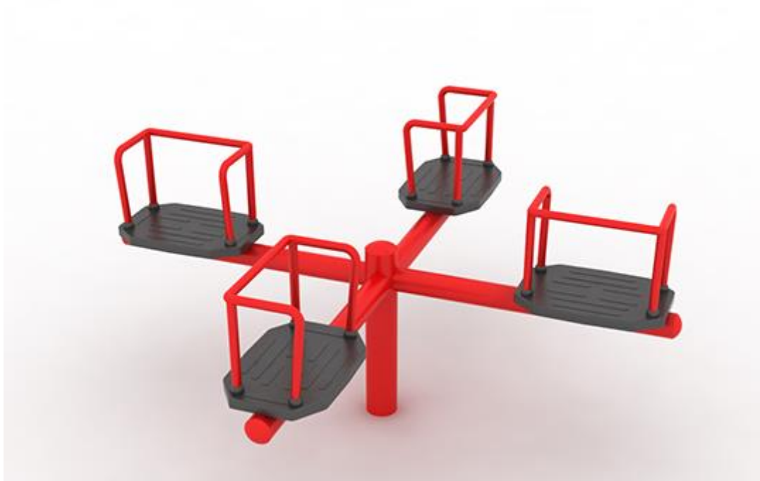
Karuzela- konstrukcja stalowa - cynkowana ogniowo i malowana proszkowo, siedziska gumowe. Wymiary: średnica: 1,84m; wysokość: 0,85m.
