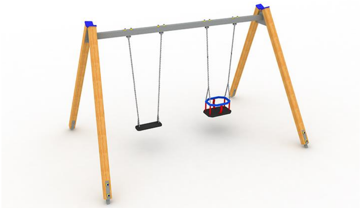
Huśtawka(dwa siedziska)- łańcuch atestowany - stal nierdzewna; belki nośne 100x100 mm - drewno klejone; belka pozioma metalowa 80x80mm - cynkowana ogniowo; kotwy stalowe - cynkowane ogniowo. Wymiary: Szerokość: 3,62 m, Długość: 2,48 m, Wysokość: ~ 2,20 m.
