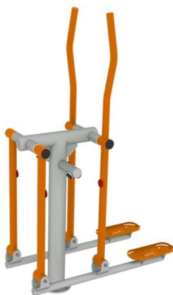
Narciarz- Konstrukcja nośna - rury stalowe o przekroju 88,9 mm x 3,6 mm , pozostałe elementy rury stalowe 48,3 mm x 3,2 mm, stopnice i siedziska wykonane z blachy stalowej o gr. 3mm, zakończenia rur zaślepione, nakrętki kołpakowe ocynkowane , zabezpieczone przed odkręceniem , łożyska zamknięte bezobsługowe, urządzenie wyposażone w amortyzatory gumowe – tłumiące uderzenia montowane na kotwach stalowych, wszystkie elementy metalowe, poddane obróbce strumieniowo-ściernej a następnie malowane proszkowo podkładem cynkowanym oraz farbą proszkową poliestrową odporną na warunki atmosferyczne i promienie UV . Wymiary: wysokość : 175 cm, szerokość : 110 cm, długość:55cm.
