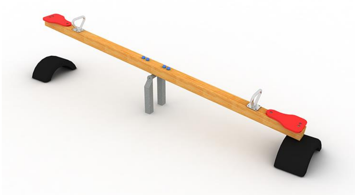
Huśtawka wagowa- Belka pozioma 100x100mm - drewno klejone, siedziska - płyta HDPE, uchwyty - stal nierdzewna , kotwa stalowa - cynkowana ogniowo. Wymiary: Szerokość: 0,29 m Długość: 2,99 m, Wysokość: ~ 0,9 m.
